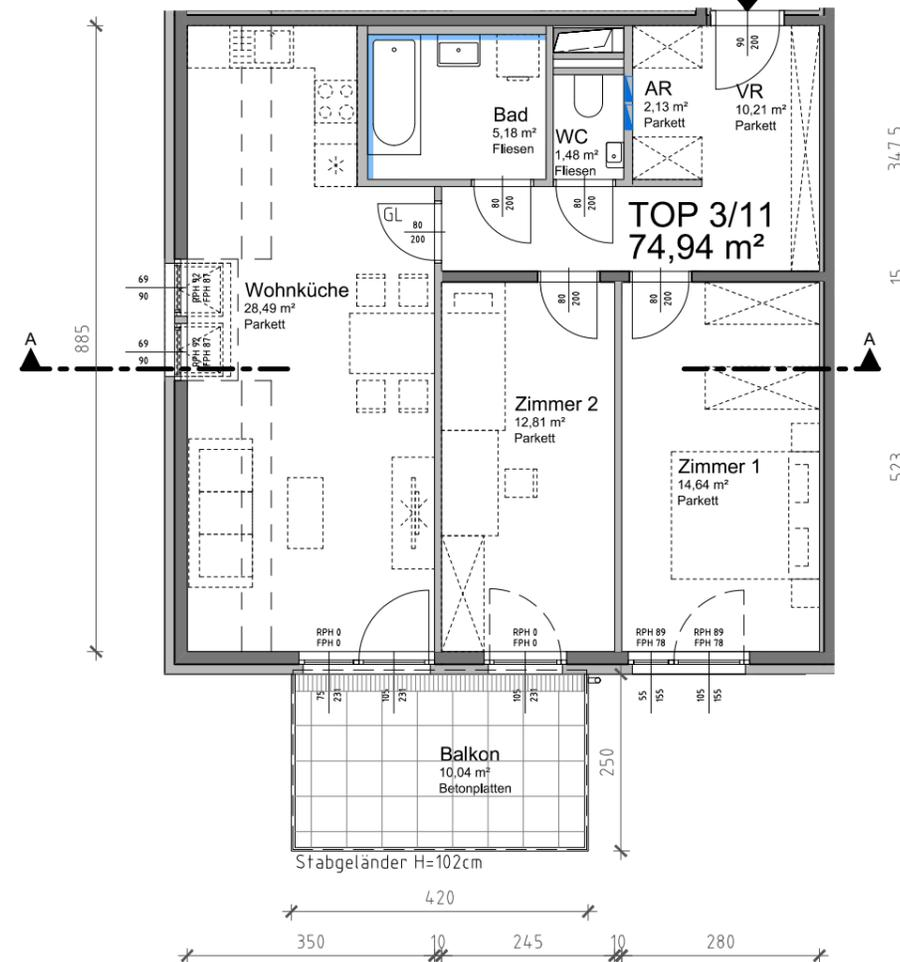
Türbeschriftungen - Durchgangsbreite / Durchgangshöhe
