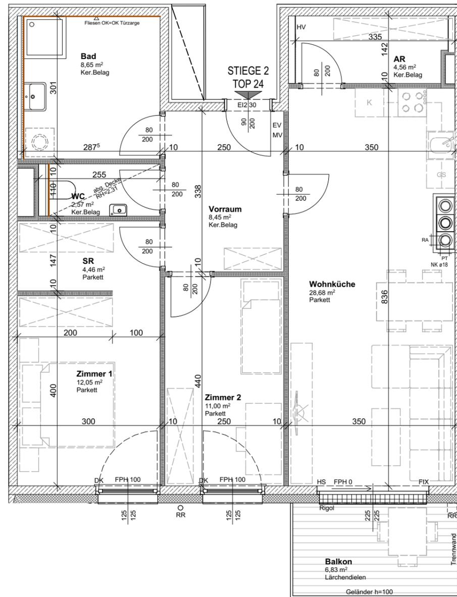
**LEGENDE:** FPH fertige Parapethöhe, STUK Sturzunterkante, DK Dreh-Kipp, HS Hebe-Schiebe, FIX Fixverglasung, RR Regenrohr, RH Raumhöhe, AR Abstellraum, VR Vorraum, SR Schrankraum, GS Geschirrspüler, KG Kühlschrank, Gefrierschrank, WM Waschmaschine, LÜ Lüftung, HV Heizungsverteiler, EV Elektroverteiler, MV Medienverteiler, RA Rauchfang Anschluss, Fliessen
